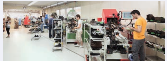
Schuh-Bodenmontage mit Zwickmaschinen
